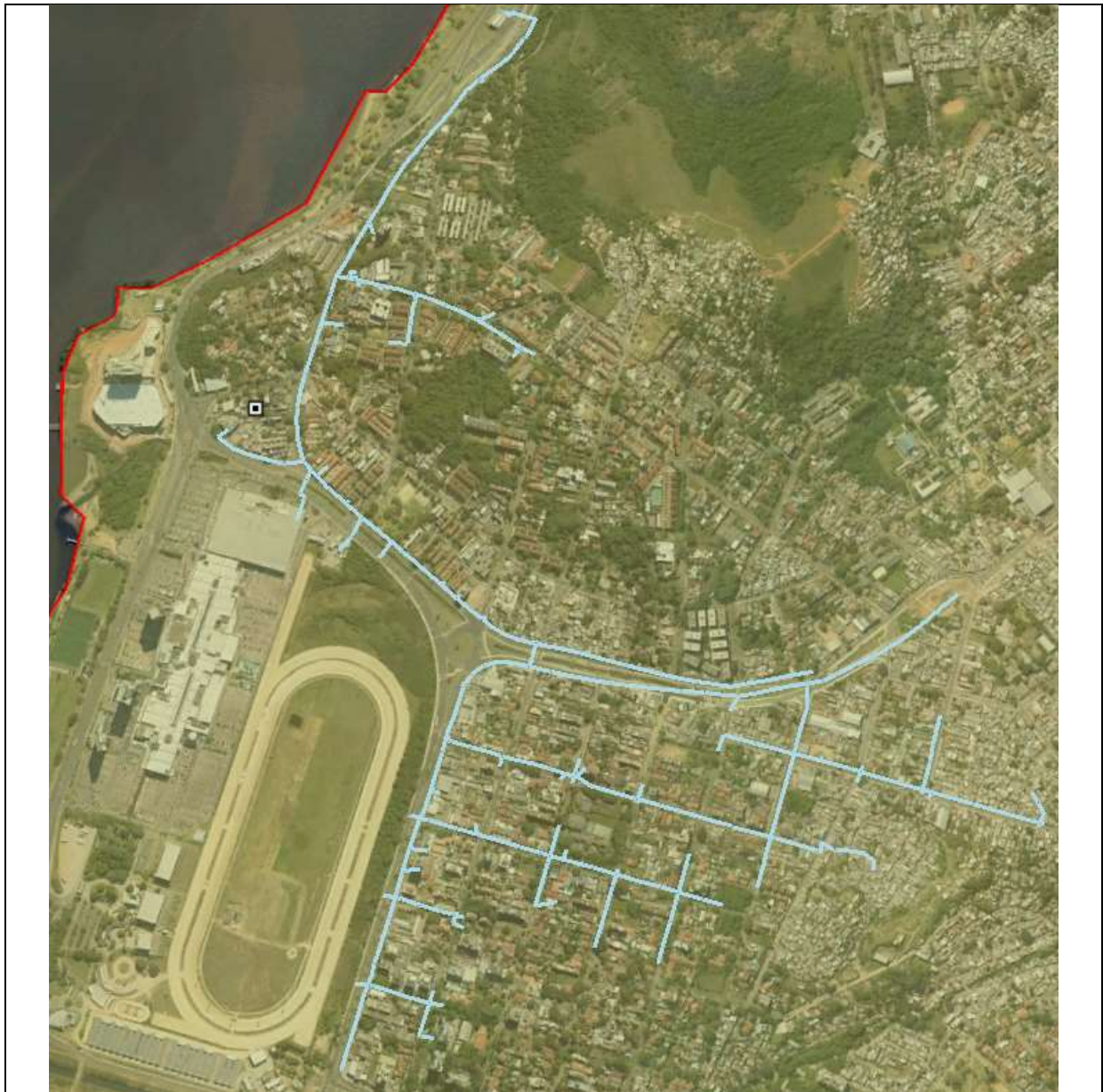
Figura 5 – Rede do SDMT do Circuito Alimentador MDE-5, atingidos pelas inundações e localização das ocorrências.
