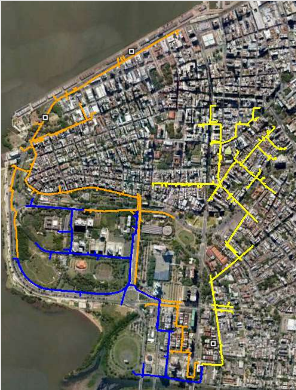
Figura 4 – Rede do SDMT dos Circuitos Alimentadores PAL4-42, PAL04-47 e PAL04-46, atingidos pelas inundações e localização das ocorrências.
